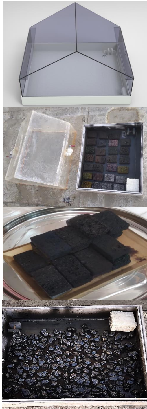
شکل ۱- نمای کلی از آب شیرین کن خورشیدی شناور و ماده ذخیره کننده انرژی (سنگ ریزه) استفاده شده در آن
