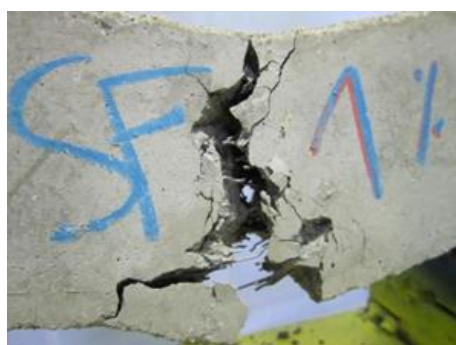
شکل ۷- نقش الیاف در جلوگیری از گسترش ترک‌ها در آزمایش خمشی نمونه با یک درصد الیاف
