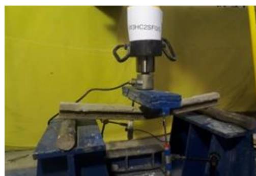
شکل ۱۴- آزمایش خمش بر روی تیر w3hc2sf0.5
