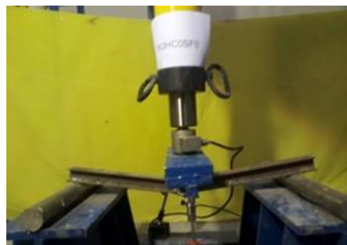
شکل ۱۳- آزمایش خمش بر روی تیر w3hc0sf0
