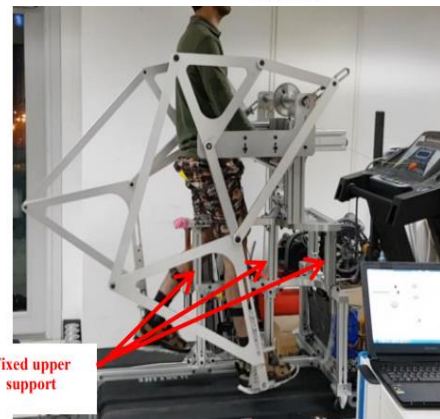
شکل ۱- مکانیزم توانبخشی راه رفتن مورد مطالعه و تعریف پارامترهای مکانیزم جنسن آن [۱۳]
