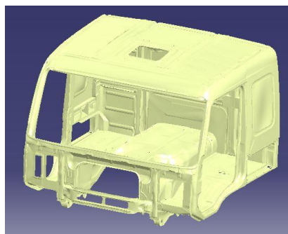
شکل ۵- شبیه‌سازی سه‌بعدی کامل بدنه خودرو
