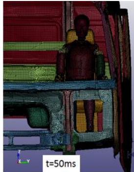
شکل ۱۰- انفجار در زیر کامیون بهبود یافته
