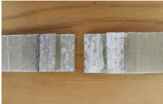
شکل ۵- یک نمونه شکست در لایه چسب در اثر خرابی خستگی
