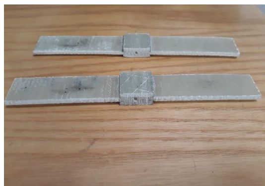
شکل ۲- نمونه‌های آماده شده نهایی اتصال چسبی دولبه
