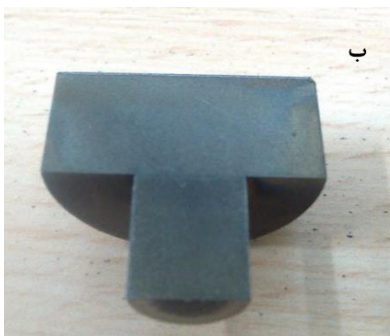
شکل ۲- تصویر نمونه جوشکاری شده: الف) قبل از وایرکات ب) بعد از وایرکات
