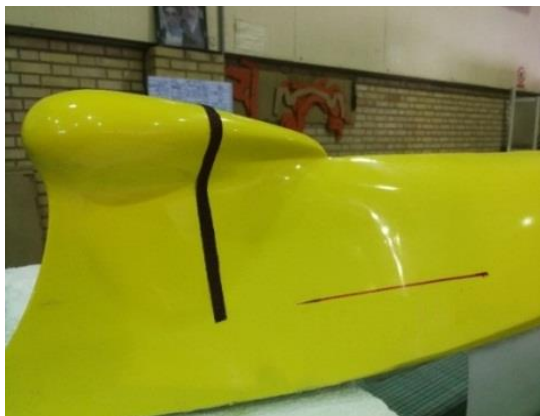
شکل ۲- نصب نوار مغشوش‌ساز جریان
