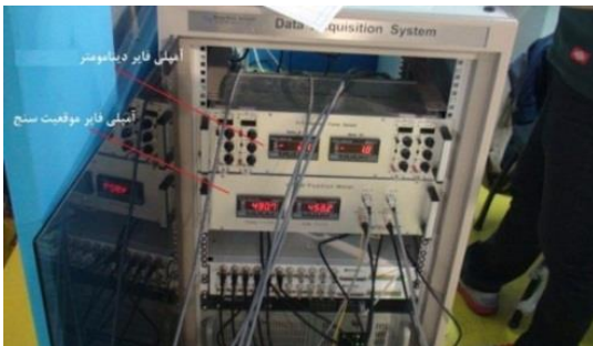
شکل ۵- آمپلی‌فایرهای دینامومتر و موقعیت سنج
