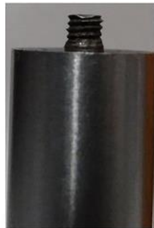
شکل ۳- الف) مشخصات هندسی و ابعادی ابزار (ابعاد بر حسب میلی‌متر) و ب) ابزار فرآیند
