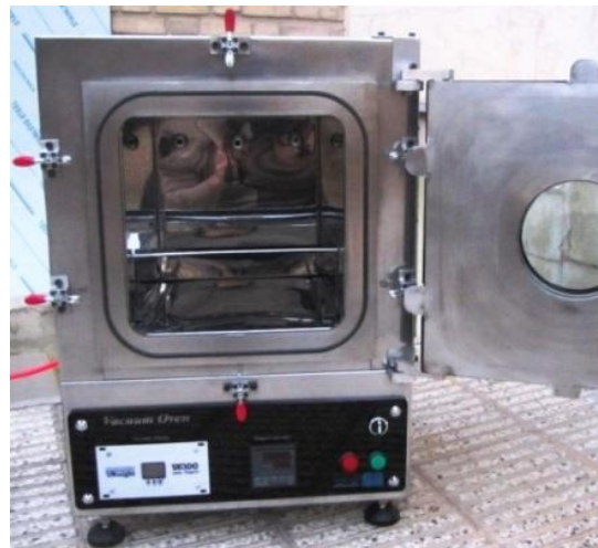
شکل ۱- مجموعه تجربی کوره الکتریکی خلاء مکعبی
