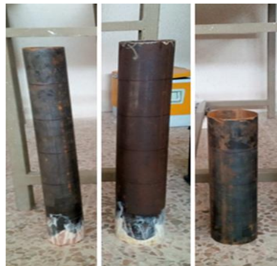
شکل ۵- پوسته‌های استوانه‌ای مورد آزمایش در طول و قطرهای مختلف
