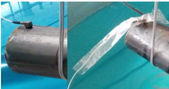
شکل ۹- نحوه نصب شتاب‌سنج روی پوسته در حالت خشک و مغروق
