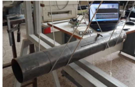
شکل ۶- نمایش دستگاه اندازه‌گیری فرکانس و نحوه نصب شتاب‌سنج به پوسته استوانه‌ای
