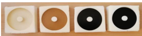
شکل ۱- نمونه‌های ساخته شده جهت آزمون سایش، از راست به چپ: اپوکسی خالص، نانولوله کربنی / اپوکسی، نانورس / اپوکسی و نانولوله کربنی / نانورس / اپوکسی
