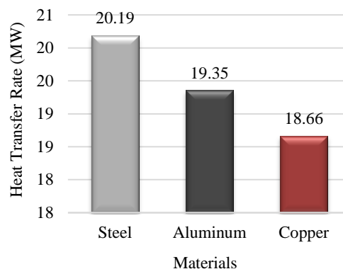
شکل ۷- تاثیر جنس صفحات ماتریس بر روی میزان انتقال حرارت در مبدل ژانگستروم
