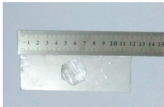
شکل ۲۱- تصویر قطعه با ترک اولیه به طول 10mm وبا وصله شش ضلعی
