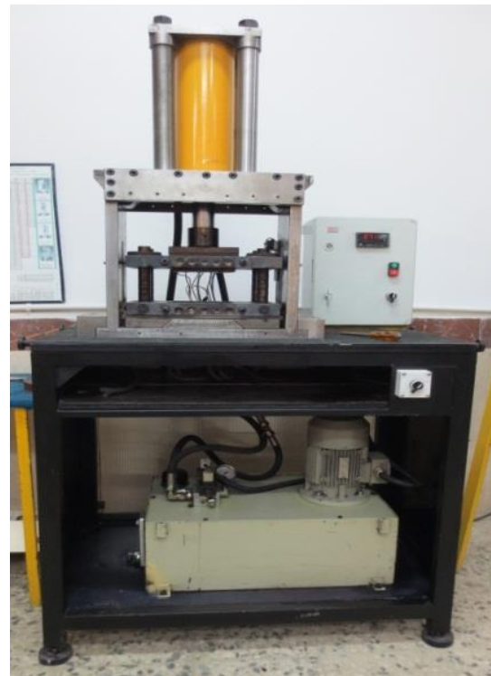
شکل ۱۱- نمایی از دستگاه دیفیوژن با قابلیت تنظیم دما و فشار
