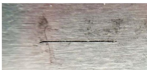
شکل ۹- تصویری از ترک ایجاد شده توسط لیزر به طول 10mm با بزرگنمایی ۱۰ برابر
