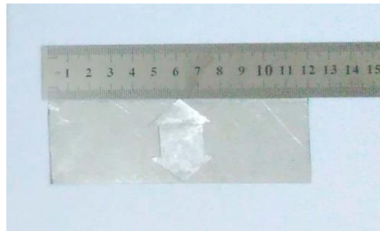
شکل ۲۰- تصویر قطعه با ترک اولیه به طول 10mm وبا وصله پیکانی
