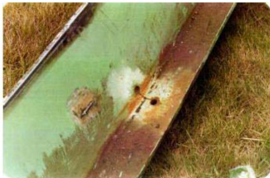
شکل ۲- ترمیم ترک با سوراخ متوقف کننده
