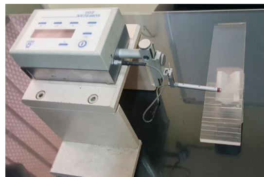
شکل ۵- اندازه گیری زبری سطح PMMA با زبری سنج
