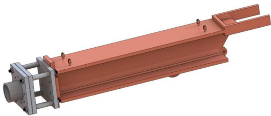
شکل ۱- سامانه آونگ بالستیک آزمایشگاه ضربه و انفجار
