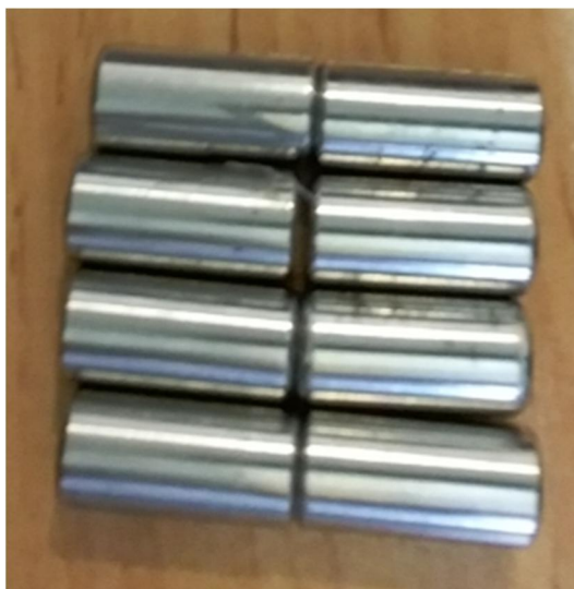
شکل ۶- پرتابه استفاده شده در این آزمایش جرم پرتابه مورد استفاده در این آزمایش ۱۲ گرم است.
