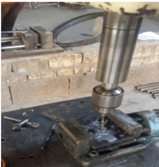
شکل ۴- سوراخ کردن صفحات به قطر سوراخ‌های متفاوت توسط دستگاه فرز انگشتی
