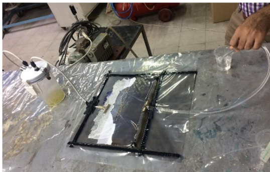
شکل ۷- فرآیند ساخت ورق کامپوزیتی به روش VARTM
