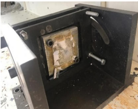
شکل ۹- نمایی از هدف پس از برخورد پرتابه با سرعت ۲۴۱ متر بر ثانیه
