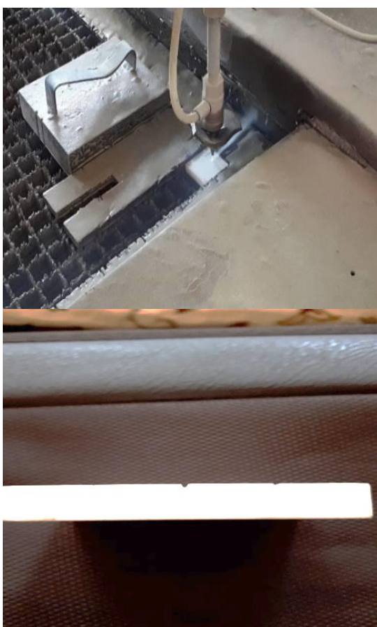
شکل ۳- نمونه‌ای از مراحل فرزکاری با جت آب و ساینده بر روی نمونه‌های سرامیکی
