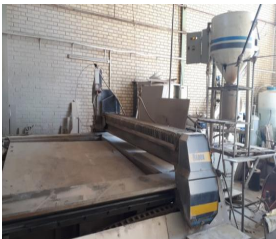
شکل ۲- دستگاه جت آب و ساینده مورد استفاده در این تحقیق
