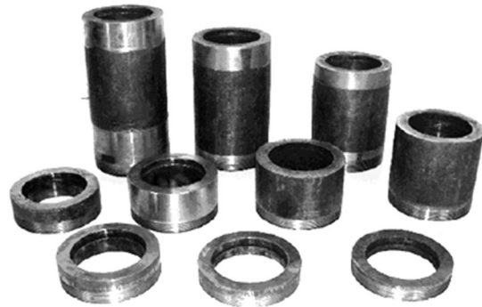
شکل ۶- لوله فولادی جهت ایجاد فاصله استقرار خرج تا ورق
