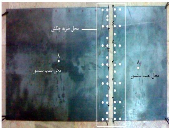
شکل ۴- مکان نصب سنسور و محل‌های ضربه زدن
