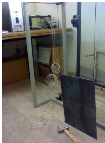
شکل ۳- نحوه آماده سازی تست برای زیرسازه‌ها
