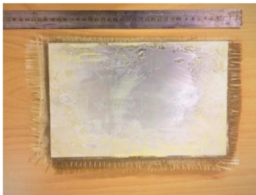
شکل ۱- نمایی از نمونه ساخته شده به صورت یک تکه با ابعاد 28 \times 18\text{ cm}^2
