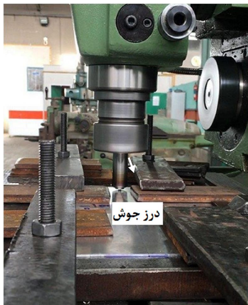
شکل ۱- جوشکاری اصطکاکی اغتشاشی نمونه مورد آزمایش
