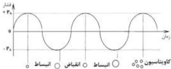
شکل ۱- ساز و کار حفره‌زایی صوتی [۲۲]
