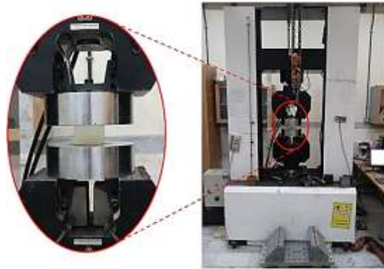
شکل ۳- نمایشی از دستگاه سنتام برای انجام آزمایش فشار محوری و نمونه فوم قرار گرفته در بین دو فک دستگاه
