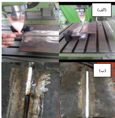
شکل ۳- الف) سامانه توزیع یکنواخت نانو مواد، ب) توزیع نانو مواد در سطح جوش
