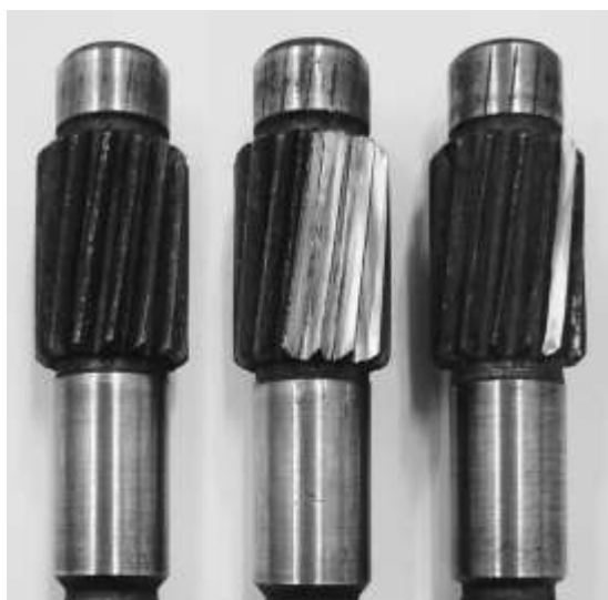
شکل ۲- شرایط چرخ‌دنده‌ها: چرخ‌دنده‌ی سمت راست: لب-بریدگی، چرخ‌دنده‌ی میانی: ساییدگی و چرخ‌دنده‌ی سمت چپ: سالم [۱۷]
