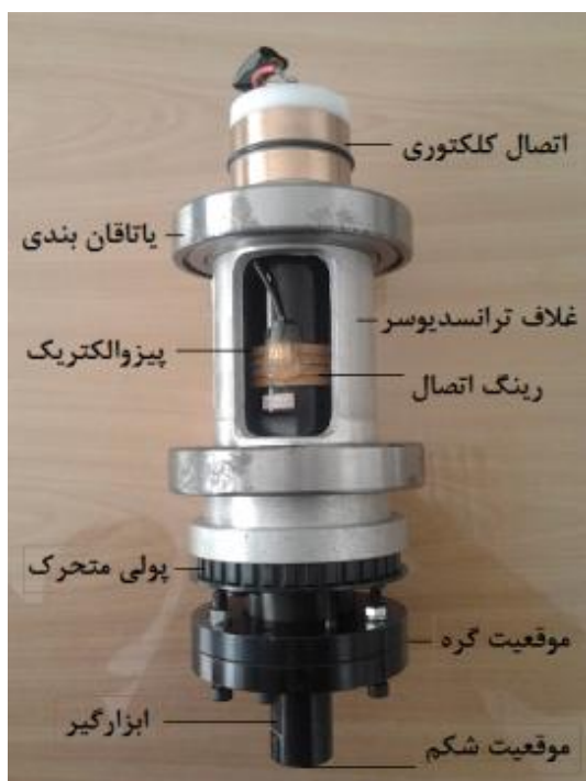
شکل ۱- سیستم انتقال ارتعاش اولتراسونیک
