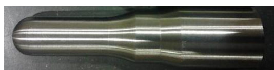
شکل ۸- ساخت ابزار شکل‌دهی مرتعش به قطر ۲۰ میلی‌متر
