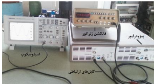
شکل ۴- تجهیزات تست و تنظیم فرکانس
