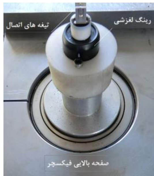
شکل ۳- مونتاژ رینگ لغزشی بر روی سیستم
