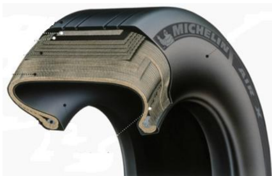
شکل ۳- اجزای تشکیل دهنده تایر هواپیما [۱۴]
