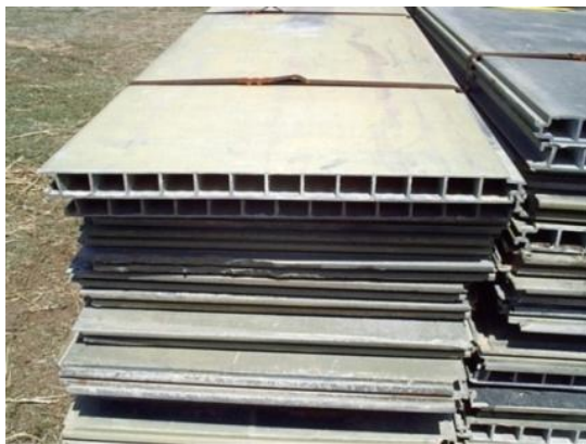
شکل ۲- نمایی از مقطع صفحات AM-2 ترمیم کننده باند فرودگاه [۲۲]
