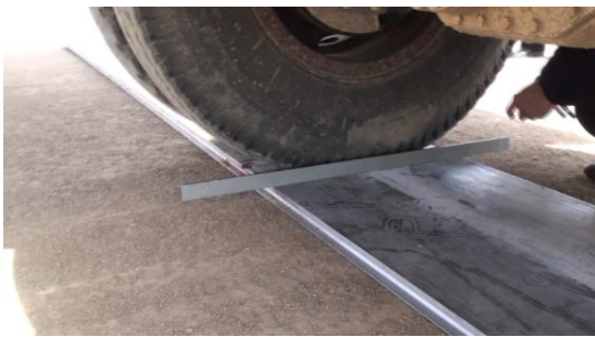
شکل ۷- تست صفحات AM-2 با کامیون و اندازه‌گیری میزان تغییر شکل ایجاد شده
