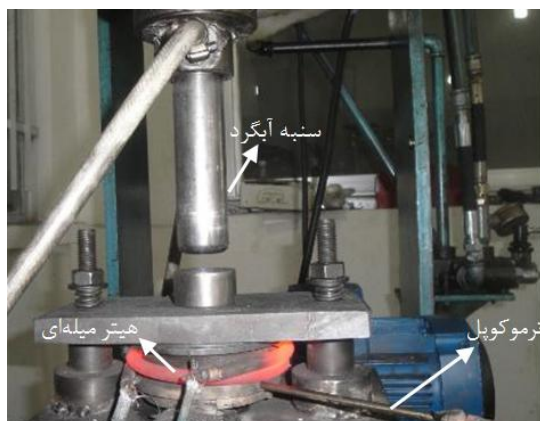
شکل ۴- مونتاژ مجموعه قالب کشش عمیق به همراه تجهیزات دمایی
