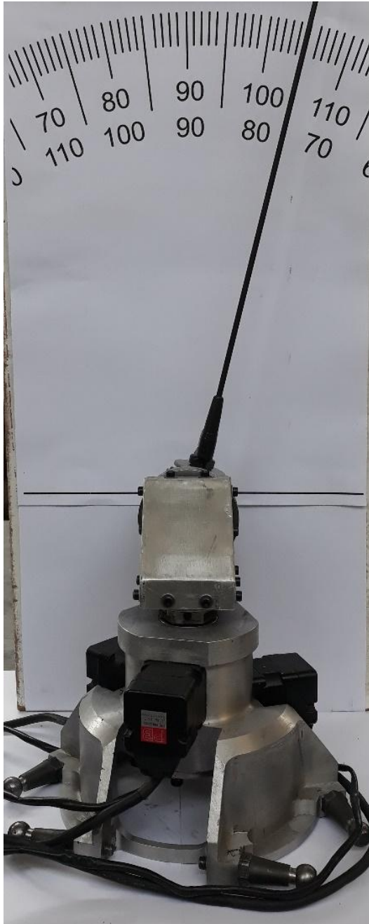
شکل ۱۷- اندازه‌گیری دقت میج به کمک صفحه مدرج
