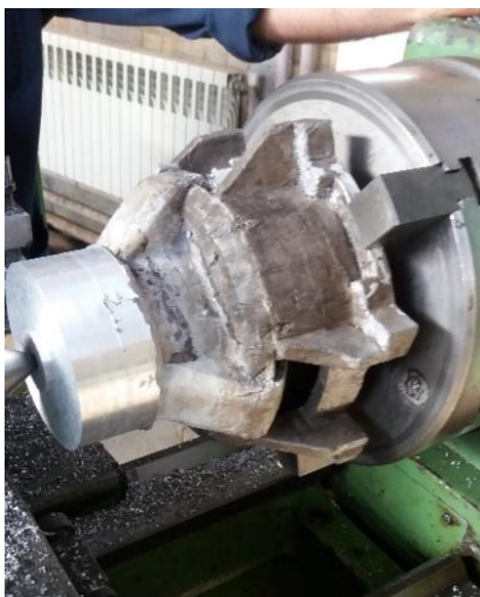
شکل ۱۳- عملیات ماشینکاری پس از ریخته‌گری
