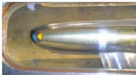
شکل ۱۰- نمایش پدیده سوپرکاویتاسیون و ایجاد ابر کاواک در اطراف اجسام
