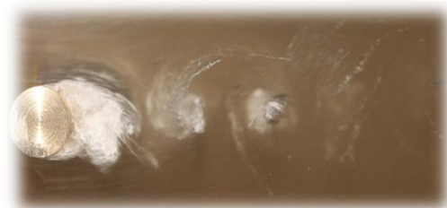
شکل ۵- نشر گردابه‌های ابری شکل در عقب حباب به صورت منظم ( \sigma=1/2 )
