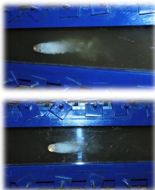
شکل ۸- در این حالت نوسان طول حباب شدید و عدد کاویتاسیون ۰/۸۷ است
