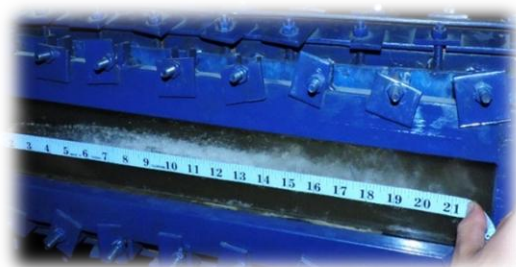
شکل ۴- اندازه گیری طول حباب از محل شروع تا انتهای آن
