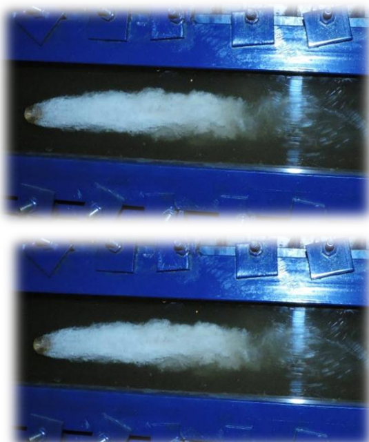
شکل ۱۰- ظاهر شدن ناحیه شفاف نقره ای در پشت مدل با عدد کاویتاسیون ۰/۶۹
