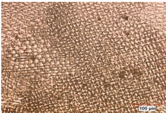
شکل ۵- ریزساختار وسط ناحیه جوش نمونه XH50
