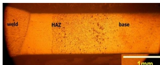
شکل ۶ - مناطق مختلف در نمونه جوش داده شده Hastelloy x
