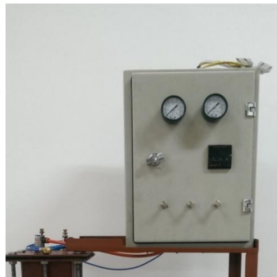
شکل ۲- تصویر سیستم حداقل مقدار روانکار
