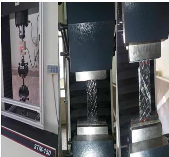
شکل ۲- نمونه در حال انجام آزمایش کشش در دستگاه یونیورسال
