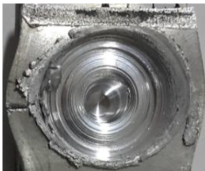
شکل ۸- نمونه جوش داده شده با صفحه پشتیبان Ti6Al4V
