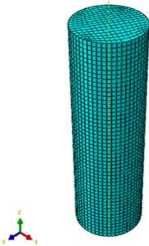
شکل ۵- نمونه‌ی مدل پوسته با سیال داخلی مورد استفاده در نرم افزار
