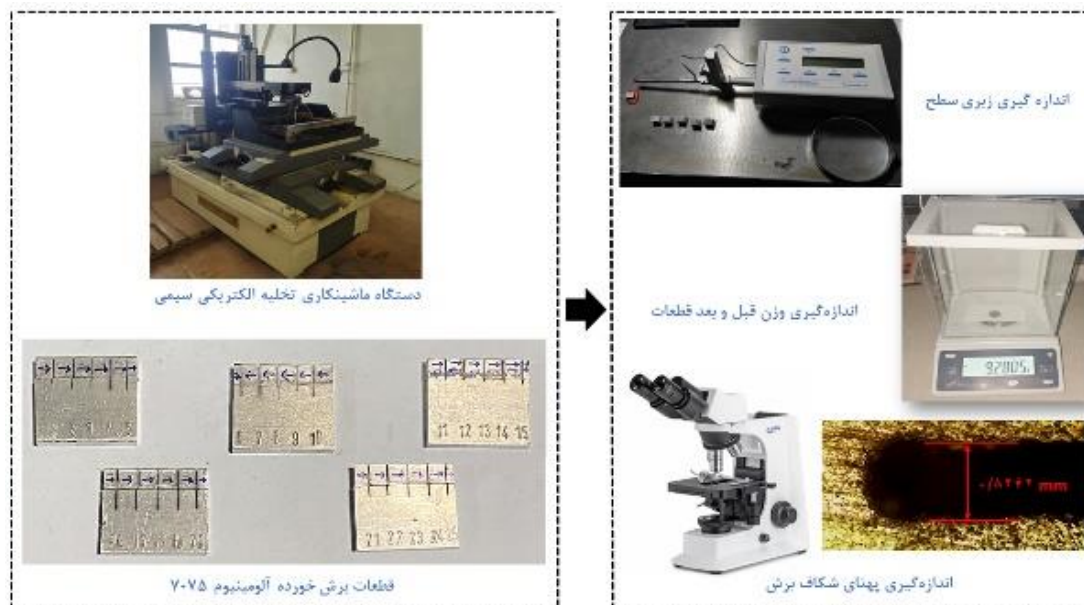
شکل ۱- چیدمان آزمایشگاهی، نمونه‌های ماشینکاری شده و تجهیزات اندازه‌گیری
