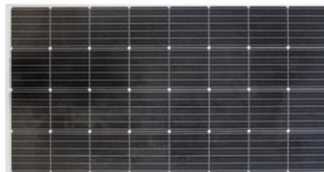
شکل ۱- پنل مونوکریستال استفاده شده در این آزمایش
