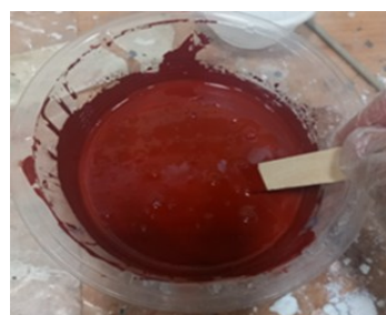
شکل ۳- رزین اپوکسی پر شده با پودر Fe_2O_3
