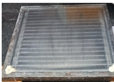
شکل ۴- قالب فولادی ساخته شده جهت ساخت نمونه‌ها
