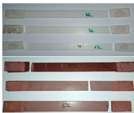
شکل ۱۸- شکست نمونه‌ها در آزمون کشش
