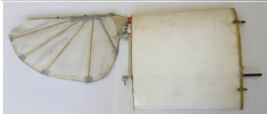
شکل ۳- نحوه تنظیم زاویه پس‌گرایی بال انعطاف‌پذیر
