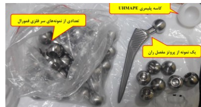
شکل ۴- تصویر واقعی تعدادی از نمونه‌های سر فمورال مصنوعی ساخته شده از فولاد زنگ نزن 316L به همراه یک پروتز مفصل ران
