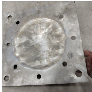
شکل ۲۳- رویه جلویی در تست تجربی انفجار با هسته مثلثی
