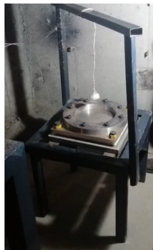
شکل ۱۱- مقید کردن ساندویچ پنل بر روی استند
