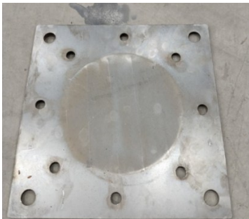
شکل ۲۴- رویه پشتی در تست تجربی انفجار با هسته مثلثی
