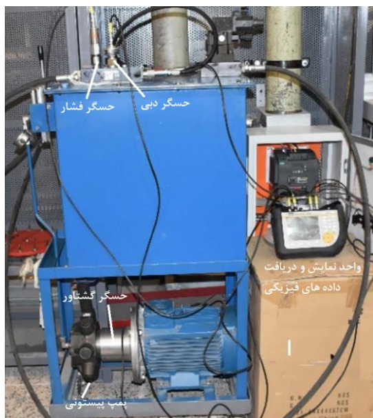
ب: واحد تولید جریان پس از ساخت و راه اندازی شکل ۱- سامانه‌ی واحد تولید جریان روغن شامل پمپ پیستون شعاعی PFR522
