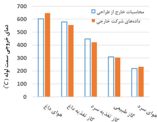
شکل ۵- مقایسه نتایج محاسبات خارج از طراحی و داده‌های شرکت خارجی برای دمای خروجی سمت لوله در دسته‌لوله‌های مختلف
