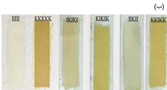
شکل ۶- (الف) شماتیک پیکربندی‌های ساخته شده و (ب) نمونه‌های آماده شده برای آزمون ضربه
