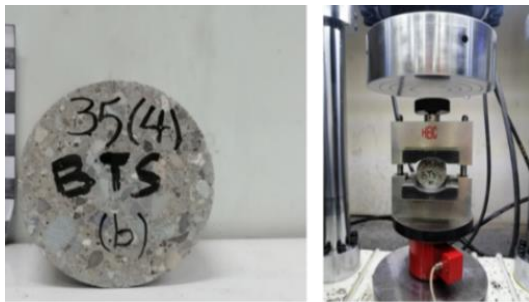
شکل ۱۳- (الف) نحوه آزمون و (ب) نمونه برزیلی مورد استفاده در آزمون مقاومت کششی برزیلی
