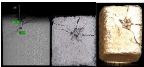
شکل ۲۲- عکس نمونه بعد از تست و نتایج اسکن برای پرتابه با زاویه برخورد ۵ درجه و سرعت برخورد ۵۵۲ m/s
