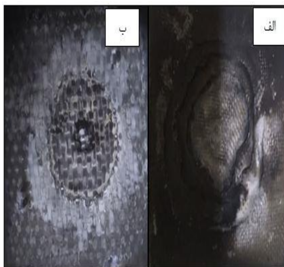
شکل ۱۲- الف) نمونه G1 بعد از تست اکسی استیلن ب) نمونه G3 بعد از تست اکسی استیلن
