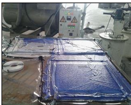
شکل ۱- ساخت صفحه کامپوزیتی به روش تزریق به کمک خلاء
